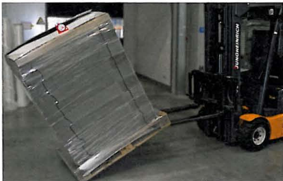
Die Folie umgibt die Palette wie ein Netz und hält sie auch in heiklen Situationen stabil.
